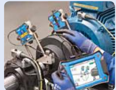
TKSA 31 je připojen USB kabely, avšak výkonem při ustavování je srovnatelný s TKSA 41.
