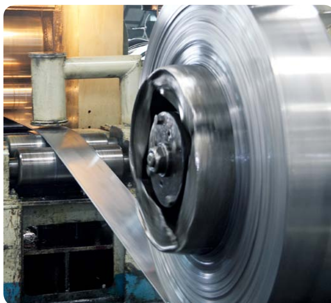
Průběžným válcováním je dosažena stejnoměrná tloušťka pásové oceli
