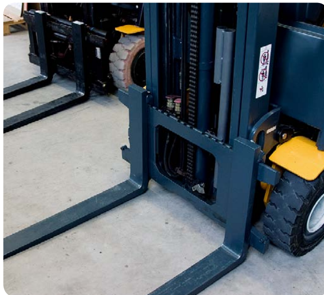
Fleyerův řetěz SKF zdvižného rámu vysokozdvizného vozíku
