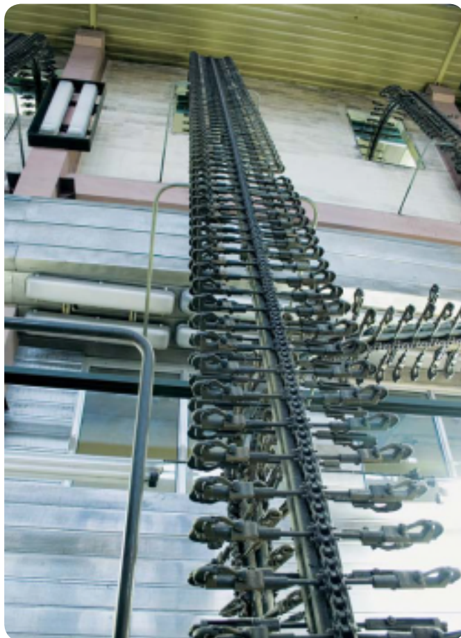
Řetěz SKF s dutými čepy používaný v dopravníku na noviny
