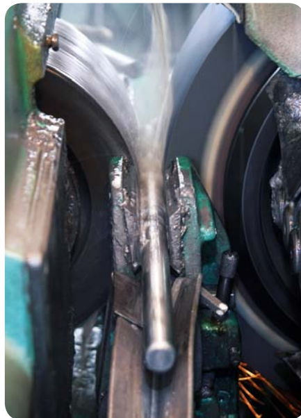
Broušení celého povrchu čepu přispívá k odolnosti proti opotřebení
